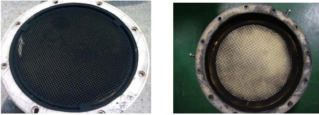
圖三：濾煙器再生前後的比較
