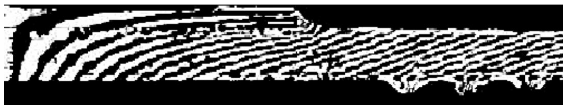
圖五(b) Moiré 雲紋干涉實驗量測水平方向變形量(100°C 降溫到 25°C)
